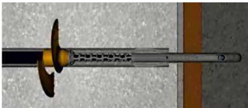
20 pav. Šiltinimo plokštės tvirtinimas sraigatine smeige
